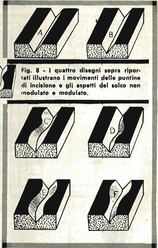
Fig. 7 - I sei disegni A-B-C-D-E-F illustrano il solco del disco stereofonico prima e dopo la modulazione. Solco monofonico non modulato (A); solco stereofonico non modulato (B); modulazione del solo canale sinistro (C); effetto del segnale del canale destro (D); modulazione di uguale intensità di entrambi i canali (E); modulazione di segnali di uguale intensità ma in opposizione di fase (F).
