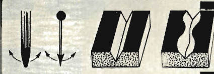
Fig. 8 - I quattro disegni sopra riportati illustrano i movimenti delle puntine di incisione e gli aspetti del solco non modulato e modulato.
